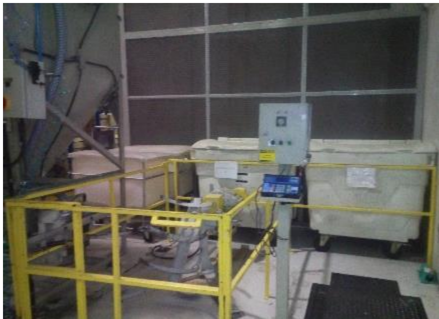
Figura 15 - Equipamento de blenda de resinas antes das modificações
