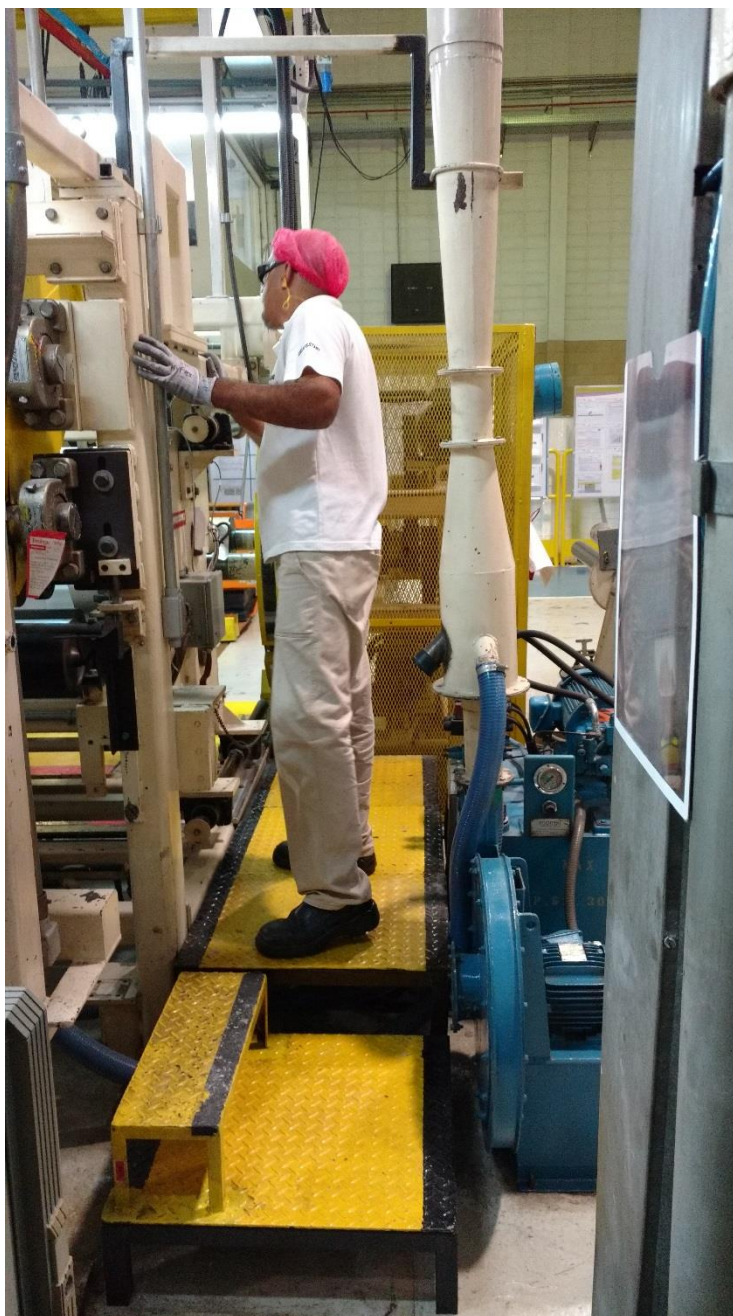
Figura 27 - Eliminação do risco de tropeçar com instalação de plataforma de trabalho
