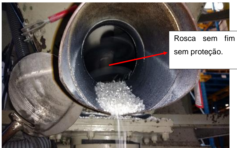
Figura 18 - Rosca do equipamento de blenda sem proteção
